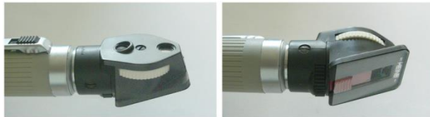
Abbildung 6: Hand-Ophthalmoskop, untersucherseitige Optik (links), patientenseitige Optik (rechts), Quelle: Jörg Piper
