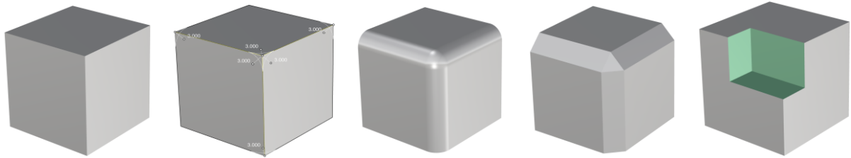
Abb. 31: Abrasive Formoperationsschritte im CAD, Quelle: eigene Darstellung
